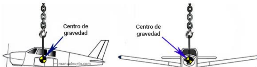
Figura N°40: Imagen referencial de centro de gravedad, balance y equilibrio.
