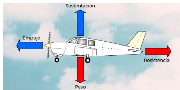
Figura N°29: Imagen referencial de fuerzas que actúan en vuelo.
