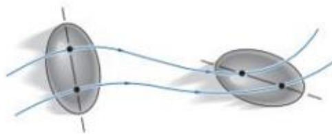
Figura N°03: Movimiento general en el plano de un cuerpo rígido.
